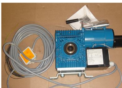
La motorisation électrique 230V mono, ou 400V tri est réalisée par un moteur BOX, intégrant un parachute de sécurité, un coffret fin de course et une manœuvre de dépannage par manivelle courte ou treuil à chaîne.
